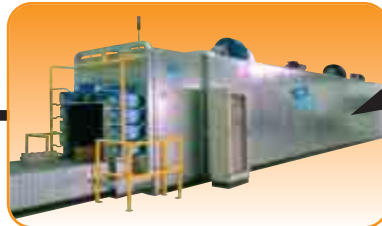
Пример установки для сушки красок на водной основе на литейных стержнях.
